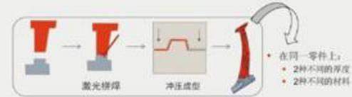
通过使用激光拼焊板，汽车工程师可以在设计中将需要的材料放在零件需要的位置上，进而实现优化的成本、重量和安全性能
